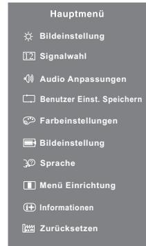
Wenn Sie z.B. die vertikale Position ändern möchten, wählen Sie das Menüelement von Bildeinstellung und drücken Sie dann auf die ENTER-Taste. Wählen Sie Geometrie mit den Tasten ◀/▶. Nach Drücken auf die ENTER-Taste erscheint eine Seite, in der Sie Einstellungen vornehmen können. Wählen Sie V. Position mit den Tasten ◀/▶.
