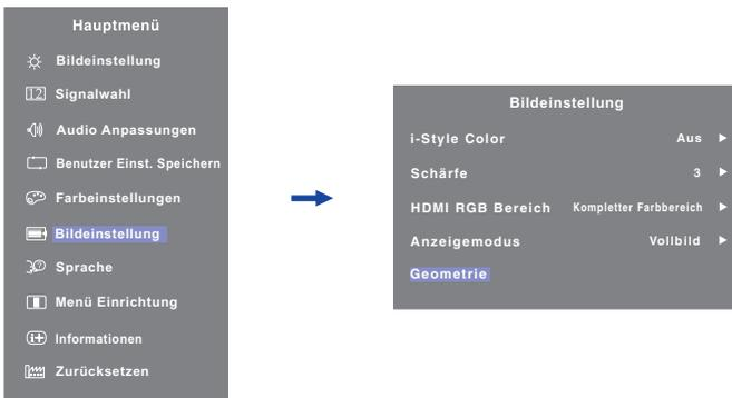
Nach Drücken auf die ENTER-Taste erscheint eine Seite, in der Sie Einstellungen vornehmen können. Verwenden Sie dann die Tasten ◀/▶, um die Einstellungen für die vertikale Position zu ändern. Hierbei sollte die vertikale Position der allgemeinen Anzeige ebenfalls entsprechend angepasst werden.
