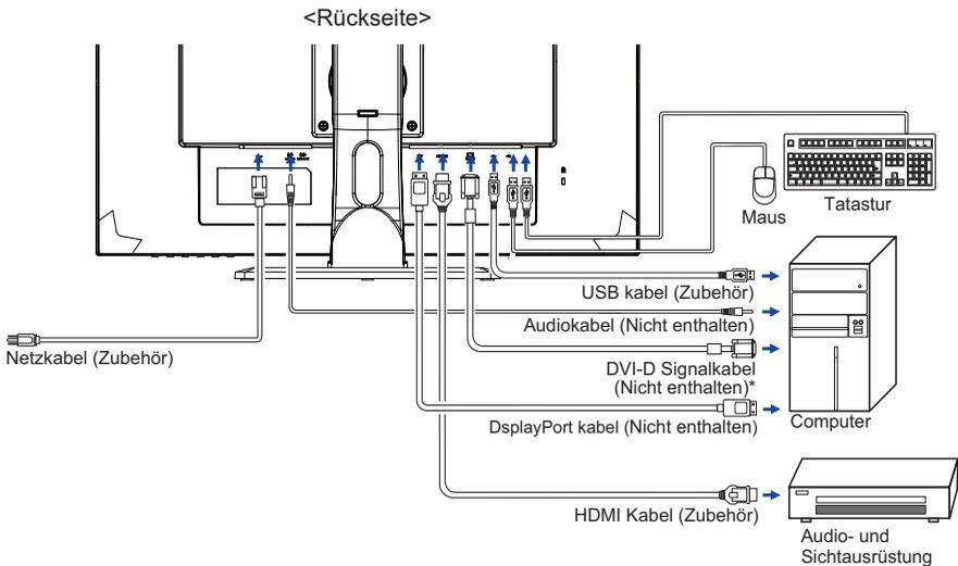
\* Das VGA (D-Sub)-Kabel ist nicht im Lieferumfang enthalten. Wenn ein qualitativ niedriges VGA (D-Sub)-Kabel verwendet wird, kann dies elektromagnetische Störungen verursachen. Bitte kontaktieren Sie das iiyama Support Center in Ihrem Land, wenn Sie den Monitor über den VGA-Eingang anschließen wollen.
